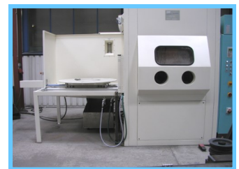
Strahlkabine mit Beladetisch
