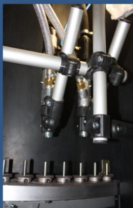
Strahldüsenbestückung mit dem Strahlkopf Typ S 180
